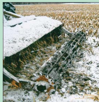
Bei Frost mulchen und lockern mit dem Dyna Drive. Den gibt es in Arbeitsbreiten von 2,1 bis 5 m für Arbeitsgeschwindigkeiten von 10 bis 15 km/ha (3 ha/h bei 3 m Arbeitsbreite mit 120 PS).
