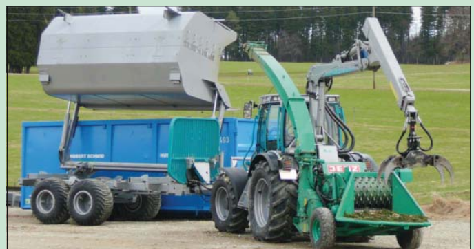
Mit dem Chip-Trailer kann man in der Rückegasse häckseln und das Hackgut auf einen Container überladen.
