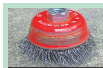
Die Zopf-Topf-Bürste löste sich mit der Zeit auf, und Drahtstücke flogen davon und dem Landwirt in die Wade. Fotos: LBG
