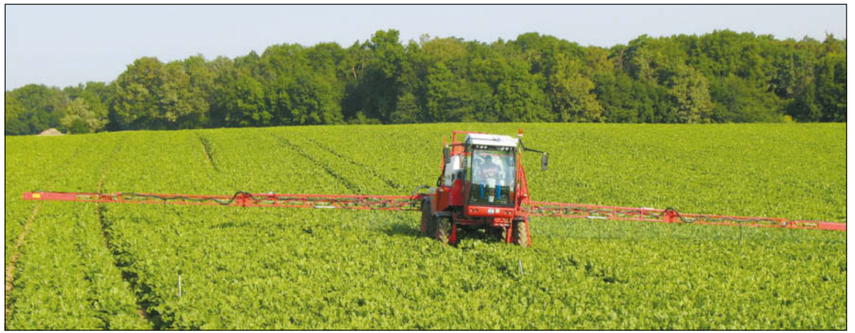
Die Bargam selbstfahrende Spritze bei der Fungizidbehandlung.
